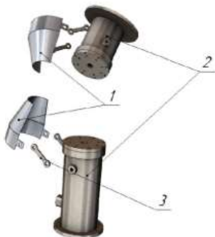
Рис. 1. Составные элементы защитного экрана: 1 – защитные экраны; 2 – корпуса электромагнитов; 3 – шарнирные держатели экранов
