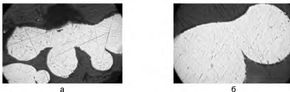
Рисунок 16 – Фрагменты поперечного сечения верхнего слоя образцов из сферического порошка титана BT1-0 фракции (-0,315+0,2) мм (а) и (-0,4+0,315) мм (б) после импульсного лазерного воздействия, x100
