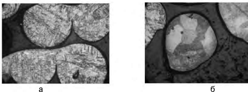
Рисунок 15 – Фрагменты поперечного (а) и продольного (б) сечения двухслойного образца из сферического порошка титана BT1-0 фракционного состава (-0,4+0,315) мм после импульсного лазерного воздействия, x100
