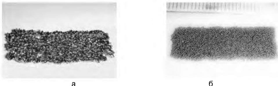
Рисунок 13 – Образование капель в монослое частиц сферического порошка титана ВТ1-0 фракционного состава (-0,315+0,2) мм, полученного в результате импульсного лазерного воздействия средней мощностью 120 Вт со скоростью сканирования 1 мм/с (а) и 7 мм/с (б)
