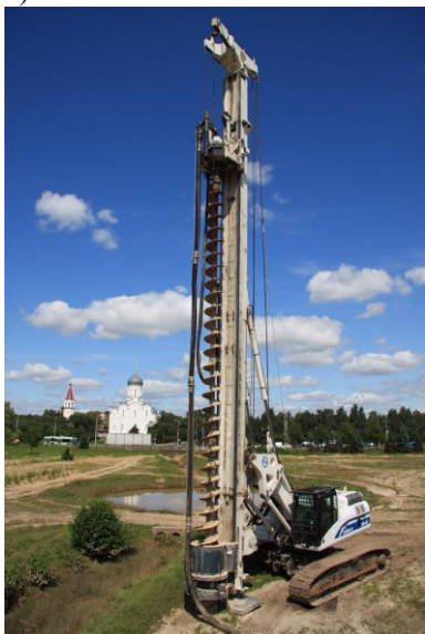
Рис. 2. Оборудование для устройства свай SFA: а – буровой станок со сплошным полым шнеком; б – буровой станок для проходки скважин; в – подъем шнека с бетоном на лопастях и погружение вибратором арматурного каркаса в скважину
