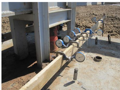
Рис. 2. Индикаторы для измерения осадки грунтовых марок
