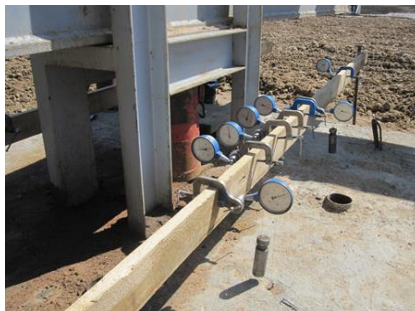
Рис. 2. Индикаторы для измерения осадки грунтовых марок
