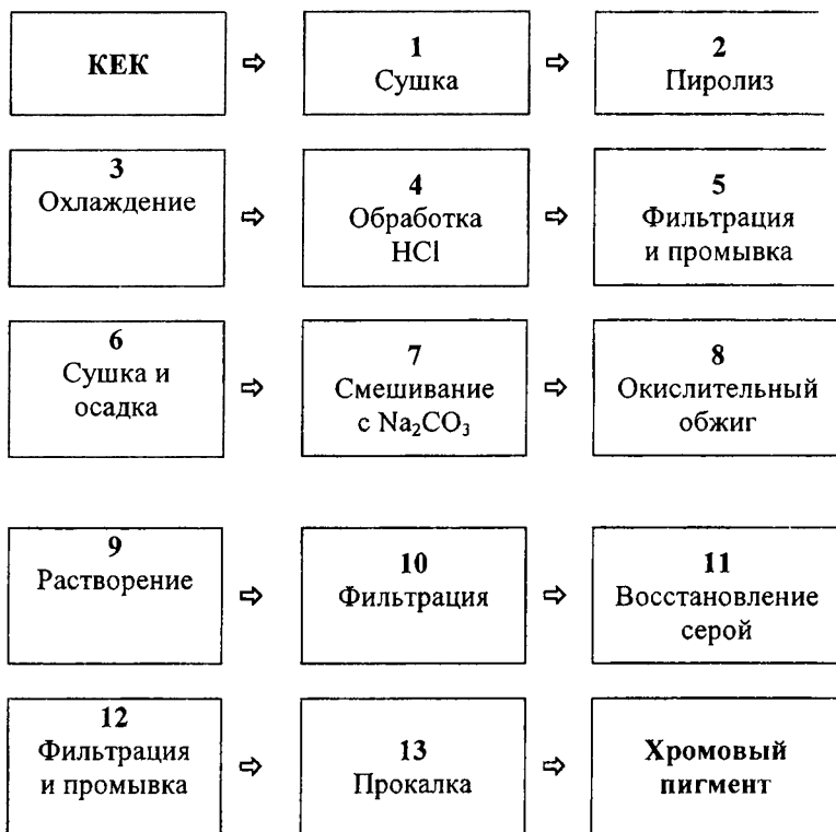
Рис. 1. Технологическая схема получения пигмента из хромосодержащих отходов кожевенного производства
