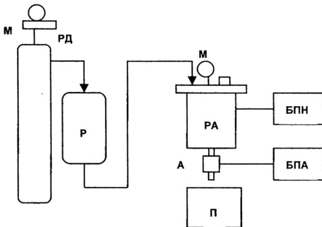
РА – реактор; А – импульсный активатор; БПА – блок питания импульсного активатора; БПН – блок питания нагревателя; П – приемник; Р – ресивер; РД – редуктор; Б – баллон с газом (азот); М – манометр
