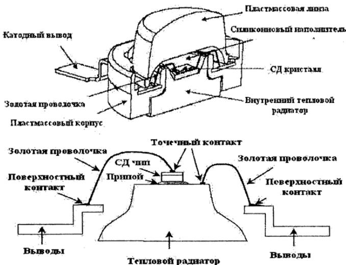
Рис.1. Конструкция и схема мощного СД
