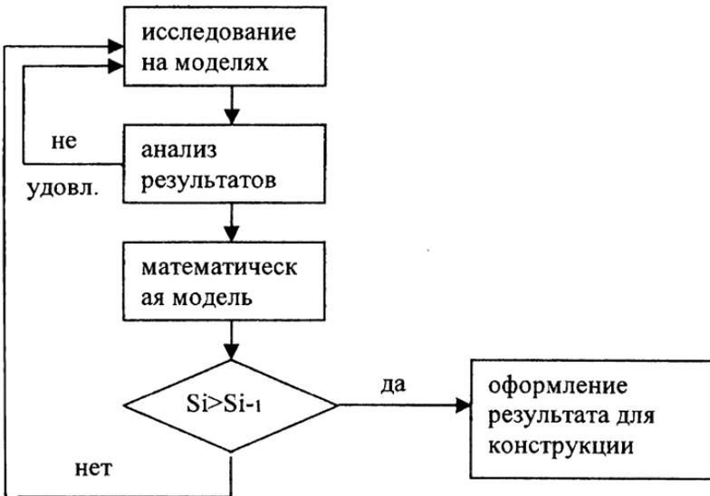
Рисунок 3 – Алгоритм создания КЛЭМП
