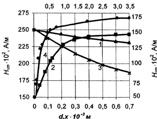
На рис. 2 изображены зависимости 1 и 2 максимальной тангенциальной составляющей магнитного поля  $H_{\tau m}$  на поверхности материала из алюминия от
