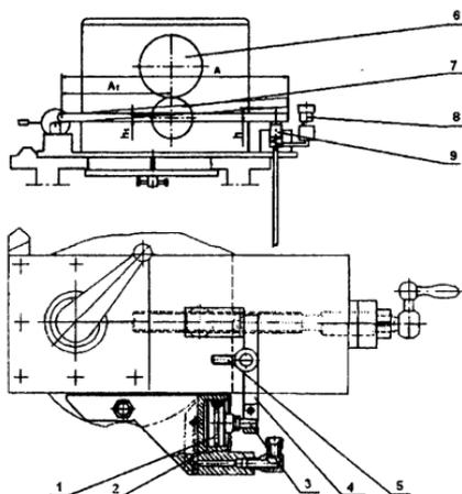
Рис. Устройство для дробления стружки
