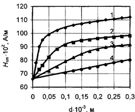
На рис. 1 изображены зависимости максимальной тангенциальной составляющей напряженности магнитного поля на поверхности образца из алюминия  $H_{\tau_m}$  от толщины образца  $d$  для времен нарастания импульсов тока первичного источника поля  $t_{max}$  соответственно: 1 –
