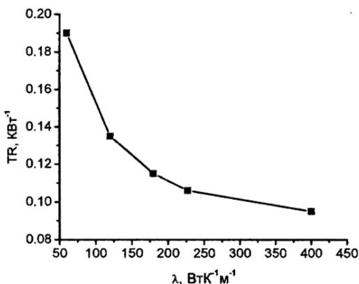
Рис.3. Расчетная зависимость теплового сопротивления TR от теплопроводности материала радиатора  $\lambda$ .
