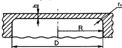
Рисунок 1 – Мембрана, выполненная за одно целое с корпусом
