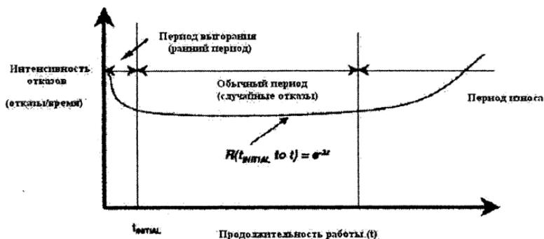
Рис.2. Типичный график интенсивности отказов
