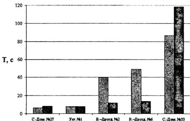
Рисунок 2 — Изменение кинематической вязкости разных образцов нефтей, 8 атм
