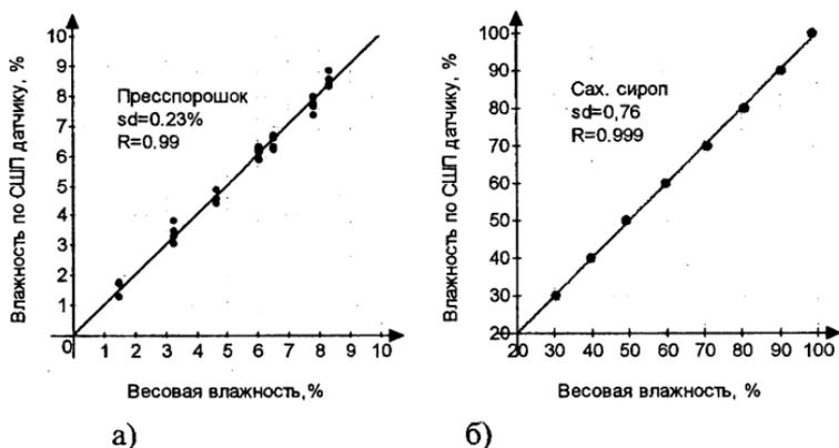
Рис. 2. Оценочные зависимости измеренной влажности от влажности, контролируемой весовым методом: а - для керамического пресспорошка, б – для сахарного сиропа
