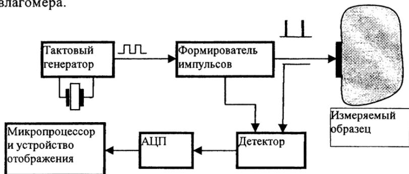
Рис.1. Блок-схема СШП измерителя влажности
