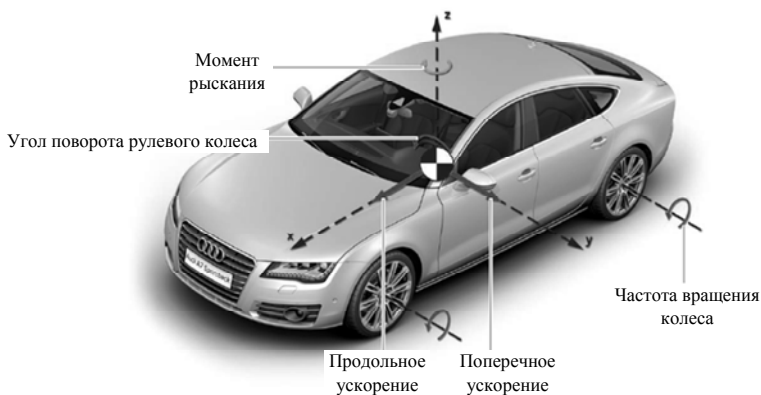
Рис. 19. Параметры, регистрируемые датчиками системы СКУ
