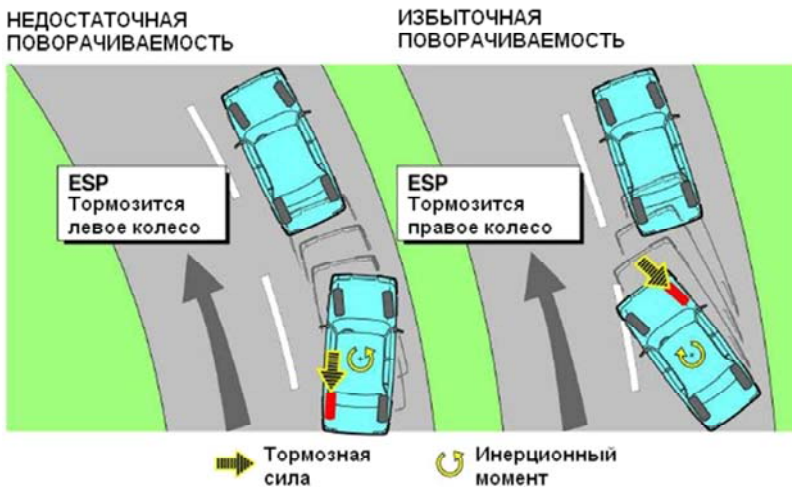
Рис. 26. Работа системы СКУ при различной поворачиваемости одиночного автомобиля
