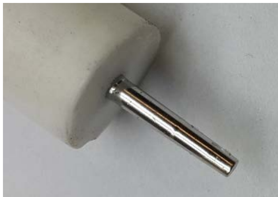
Рисунок 2 - Фотография обработанного образца с изолирующей трубкой
