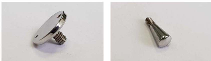
Рисунок 5 – Образцы изделий из коррозионностойкой стали после полирования с применением управляемых импульсных режимов электролитно-плазменной обработки
