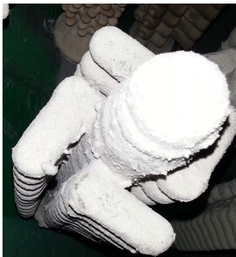
Рисунок 1 – Форма для получения отливок «Рычаг» методом литья по выплавляемым моделям
