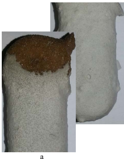
а – маршалит +жидкое стекло; б – маршалит +алюминат натрия Рисунок 2 – Образцы с различным составом пятого слоя
