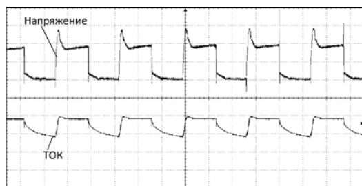
Рисунок 1 – Форма импульсов тока и напряжения при частоте 500 Гц для сплава АД1
