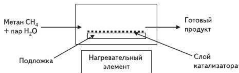
Рисунок 3 – Схема CVD технологии получения нанотрубок
