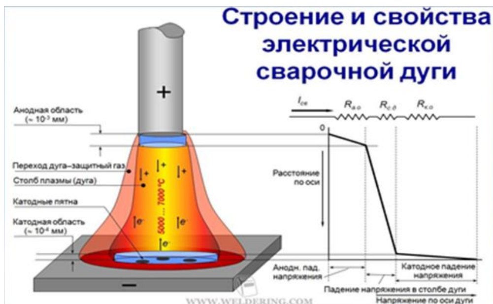
Рисунок 3 - Строение и свойство электрической сварочной дуги
