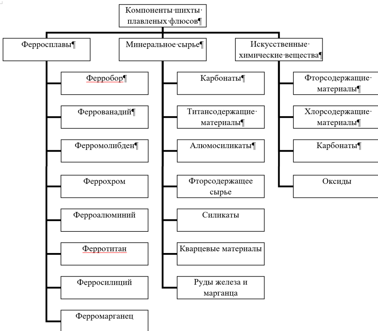
Рисунок 1 - Классификация компонентов, входящих в состав плавеных сварочных флюсов
