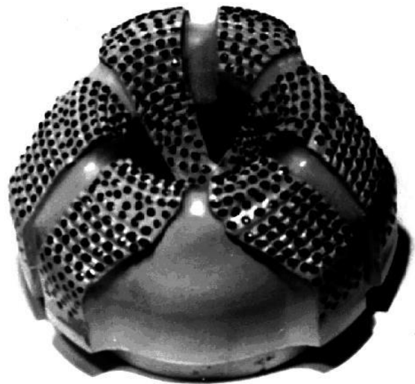
Рисунок 2 - Алмазное долото, полученное методом спекания под высоким давлением:
