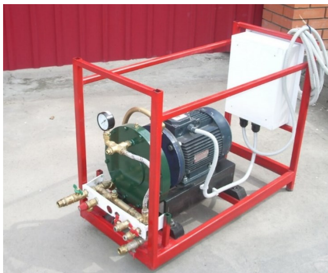
Рисунок 2 – Вихревой кавитационный теплогенератор (ВТГ)
