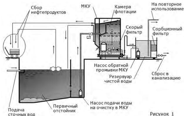
Рисунок 1 – Технологическая схема
