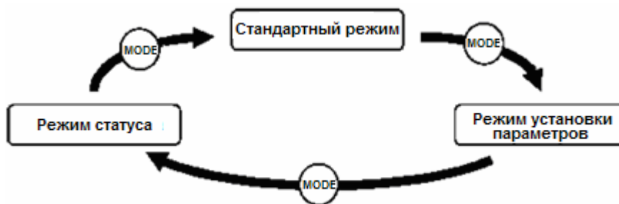
Рис. 2.2. Переключение режимов состояния инвертора TOSHIBA VF-S11
