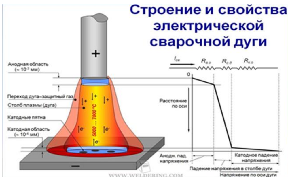
Рисунок 3 - Строение и свойство электрической сварочной дуги
