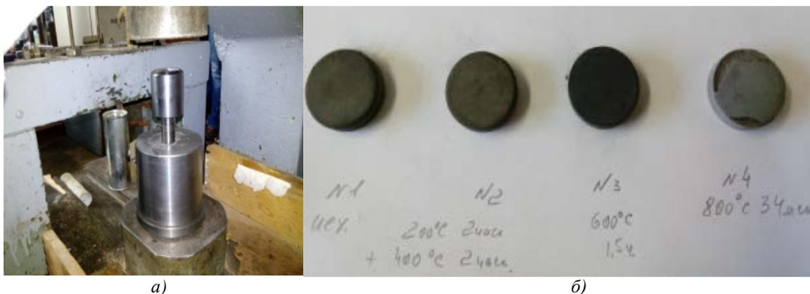
Рисунок 1 – Технологическая оснастка для отработки режимов деформации порошка комплексного силицида (а) и опытный образец полученного брикета (б)
