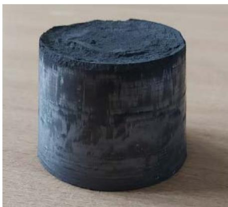
Рисунок 5 – Опытный образец катода-мишени
