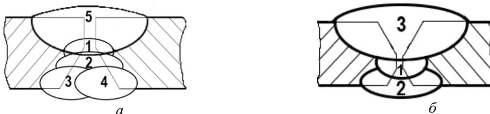
Рисунок 2 – Варианты заполнения разделки кромок при комбинированной сварке
