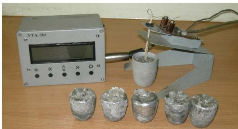
Рисунок 1 – Схема установки для термического анализа сплава олово-свинец
