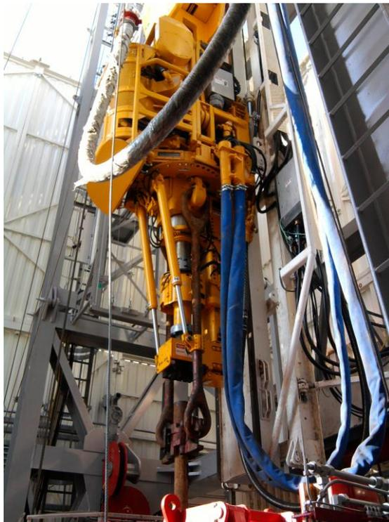
Рис. 1. Общий вид верхнего привода буровой колонны «Bentec»
