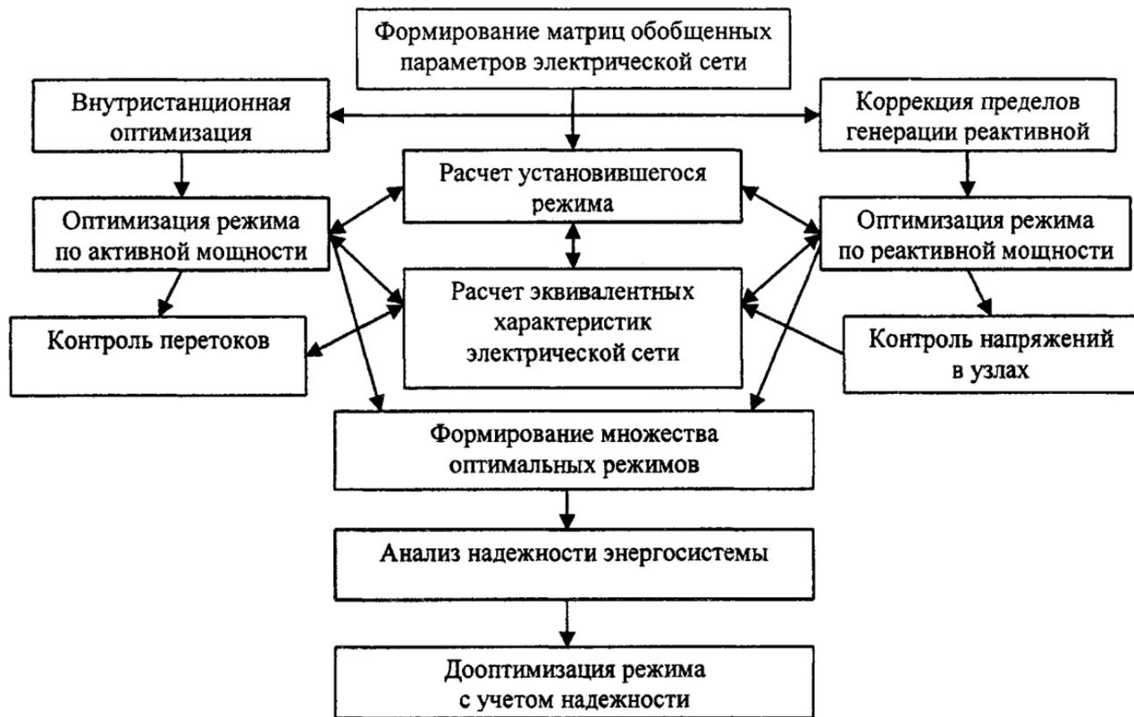
Рис.1. Структурная схема реализации задачи комплексной оптимизации
