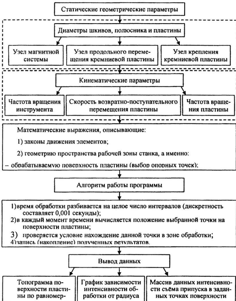
Рис. 2. Блок-схема математической модели
