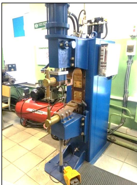
Рисунок 1 – Машина контактной точечной сварки МТ-22
