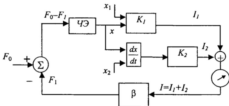
Сигналы  $x_1$  и  $x_2$  – это помехи, генерируемые в соответствующих цепях и приведенные к входам этих цепей,  $F_0$  – полезный сигнал. В данной работе показано, что в динамическом режиме измерений в узкой полосе частот имеется возможность подавления аддитивных шумов любой природы, генерируемых в цепях силового уравнивания и электронного демпфирования, вне зависимости от уровня этого демпфирования.
